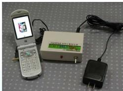
携帯電話用遠隔制御装置 **AC100V駆動**
