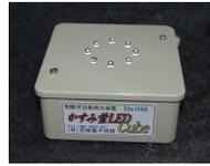
乾電池式の「かすみ蛍LED」は、その筐体の製造組立工程に時間が掛かってしまったため箱型に改良し、低価格を実現することができました。発光光度等の性能は「かすみ蛍LED」Exe10MXと同等です。
