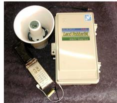
電池式警報音発生装置 **バッテリー駆動**
